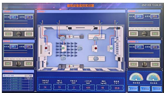
实训室温度、人员出入和环境品质监控
