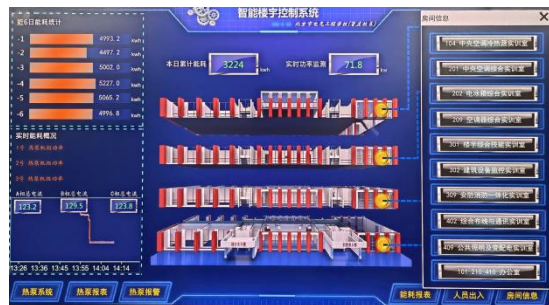
12 个实训室的暖通空调运行状态监控画面
