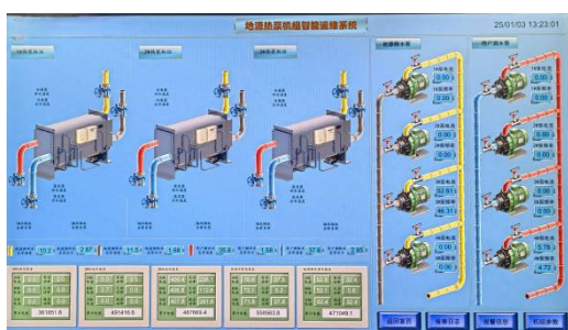
3 台地源热泵机组运行状况监控画面
