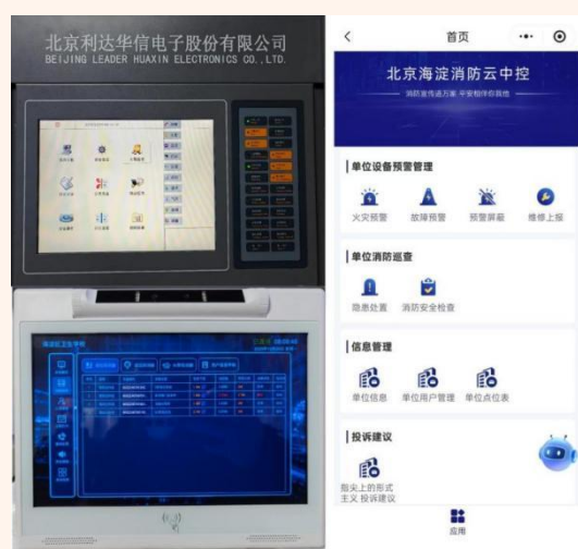
图 7-5 消防云监控智能巡查系统接入海淀区城市大脑（北京市海淀区卫生学校）
