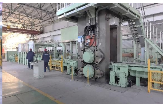
图 1-31 实验钢中试轧制
